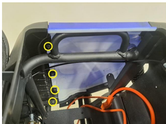
Irrota istuimen oikean alapuoleisen sivumuovin kiinnitysruuvit (ristipäämeisseli ph2).
