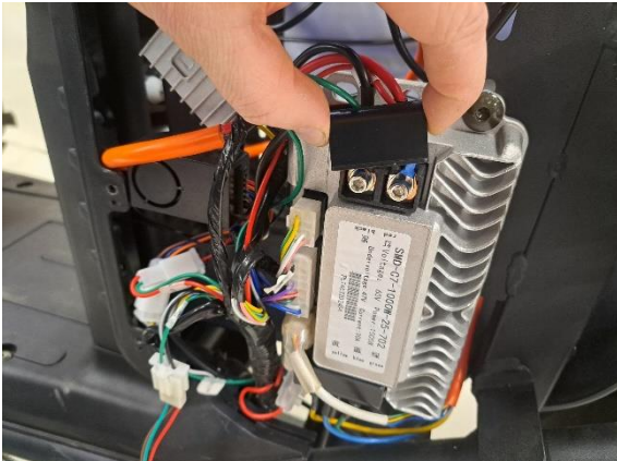
Ota ohjainlaitteen virtajohtojen suoja pois.
