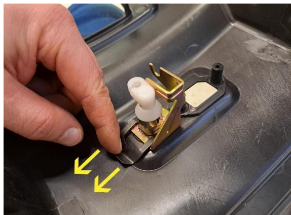
Ota istuimen lukon kiinnitys klipsu pois.
