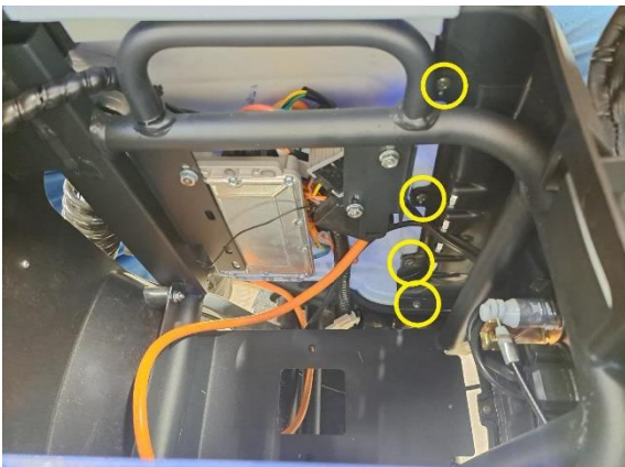
Irrota istuimen vasemmanpuoleisen alasivumuovin kiinnitysruuvit (ristipäämeisseli ph2).
