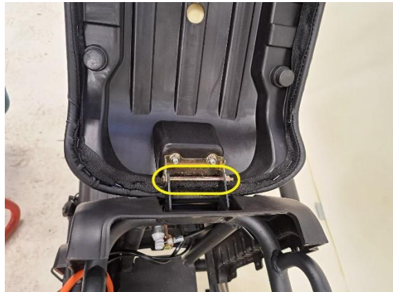
Irrota penkin kiinnityspultti (ristipäämeisseli ph2), jolla vasta mutteri (kiintoavain 10 mm).
