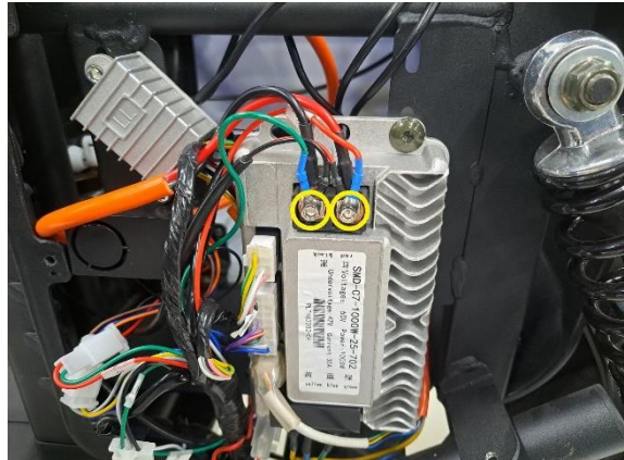
Irrota ohjainlaitteen virtajohtojen kiinnityspultit (kuusiokoloavain 4 mm).
