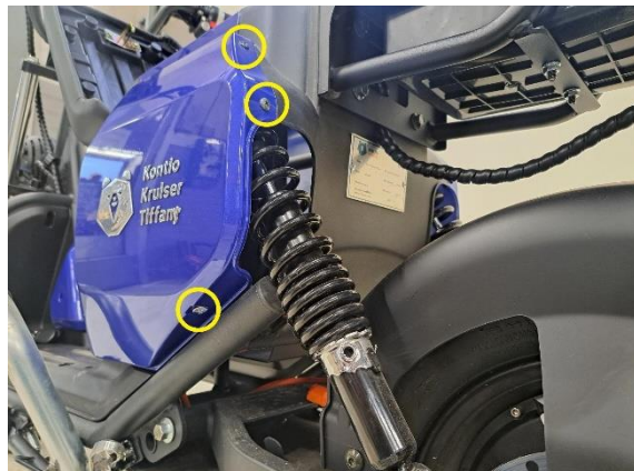
Irrota istuimen vasemmanpuoleisen alasivumuovin kiinnitysruuvit (ristipäämeisseli ph2).
